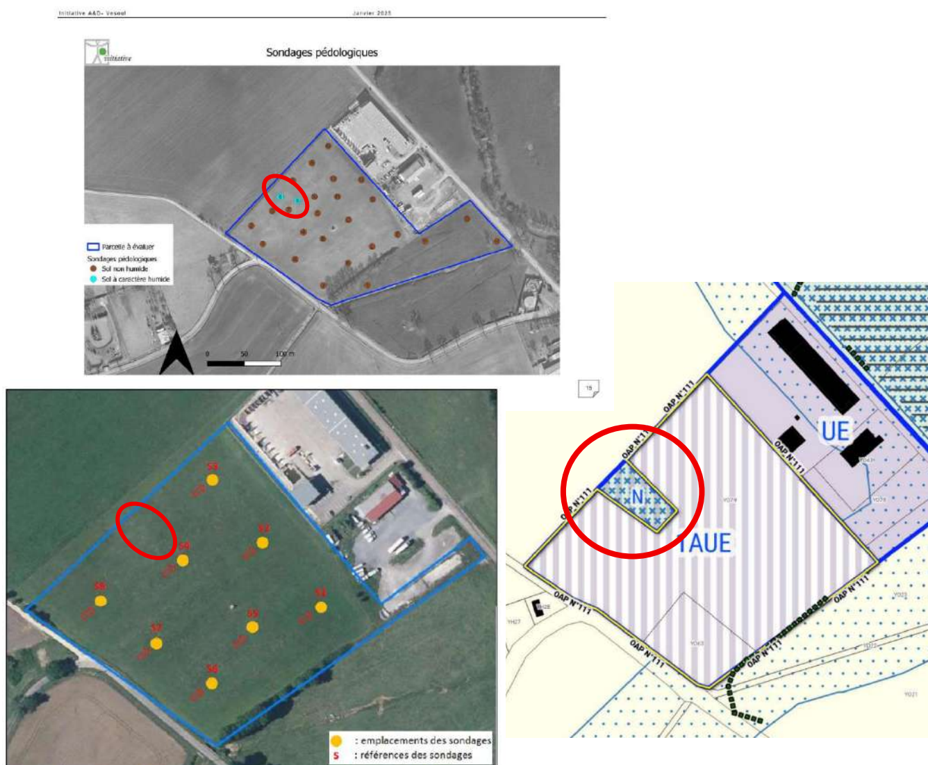
Figure 1 : Implantation des sondages de sol au sein du site d'étude (Source : TECNYDRO)
